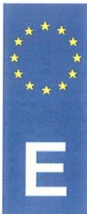
Este distintivo tendrá una altura de 98 mm y una anchura mínima de 40 mm y una máxima de 50 mm, siendo de fondo azul reflectante (referencia de Munsell 5,9 pb 3,4/15,1). Las estrellas, cuyos centros estarán situados en un radio de 15 mm y la distancia entre dos puntos opuestos de una misma estrella será de 4 a 5 mm. El citado distintivo del Estado (**E**) será de color blanco o amarillo, con una altura mínima de 20 mm y un grosor en sus trazos de 4 a 5 mm.
