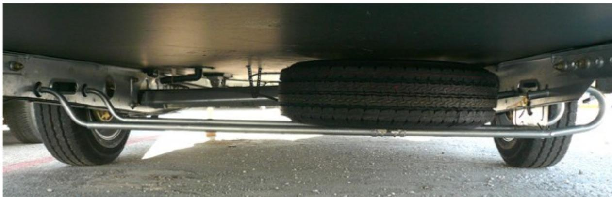
La instalación de un «mover» en una caravana (dispositivo para mover la caravana cuando está estacionada), así como la instalación de un soporte para rueda de repuesto.
