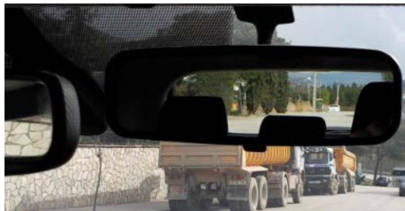
Instalación en vehículos autoescuelas de espejos retrovisores auxiliares, que facilitan la conducción del profesor y que no son están homologados por ninguna de las clases que determina la Directiva de visión indirecta 2003/97/CE, pero mejoran ostensiblemente la enseñanza y seguridad por parte del profesor de autoescuela.
