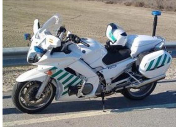
4. Los vehículos de policía, además, podrán utilizar con carácter voluntario un sistema auxiliar constituido por dos fuentes luminosas (intermitentes o estroboscópicas), de color azul. Este sistema estará instalado en el frontal del vehículo, a la altura de las luces de cruce, o por encima de ellas en el caso de las motocicletas.
