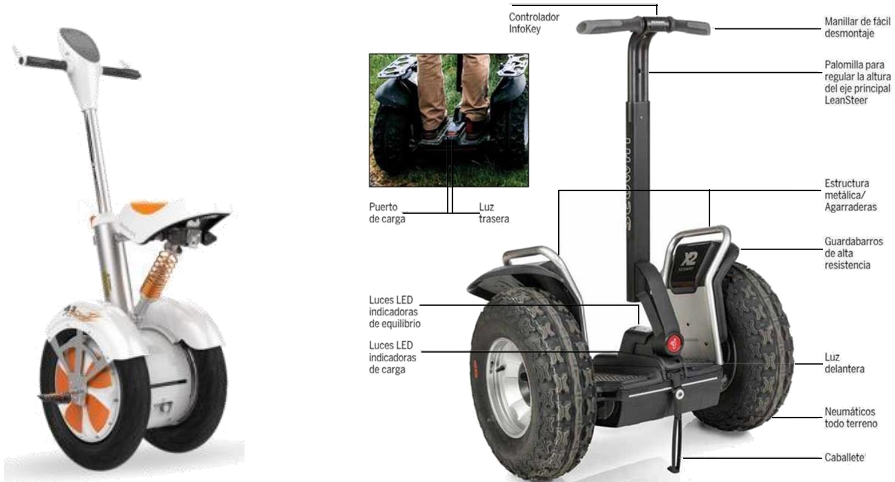
Partes de un segway
