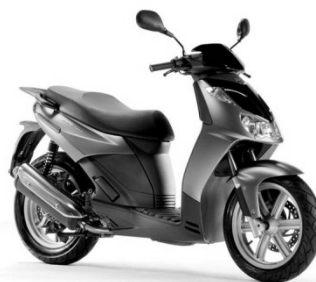
Retrovisor izquierdo obligatorio y retrovisor derecho optativo
