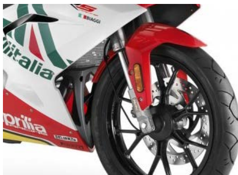
Catadióptricos laterales no triangulares de color amarillo auto
