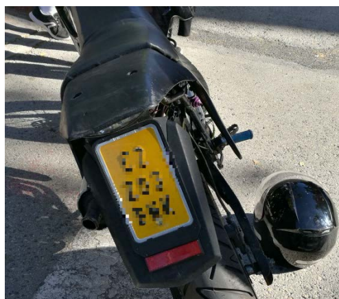
Ciclomotor que carece de intermitentes delanteros y traseros (no obligatorios)
