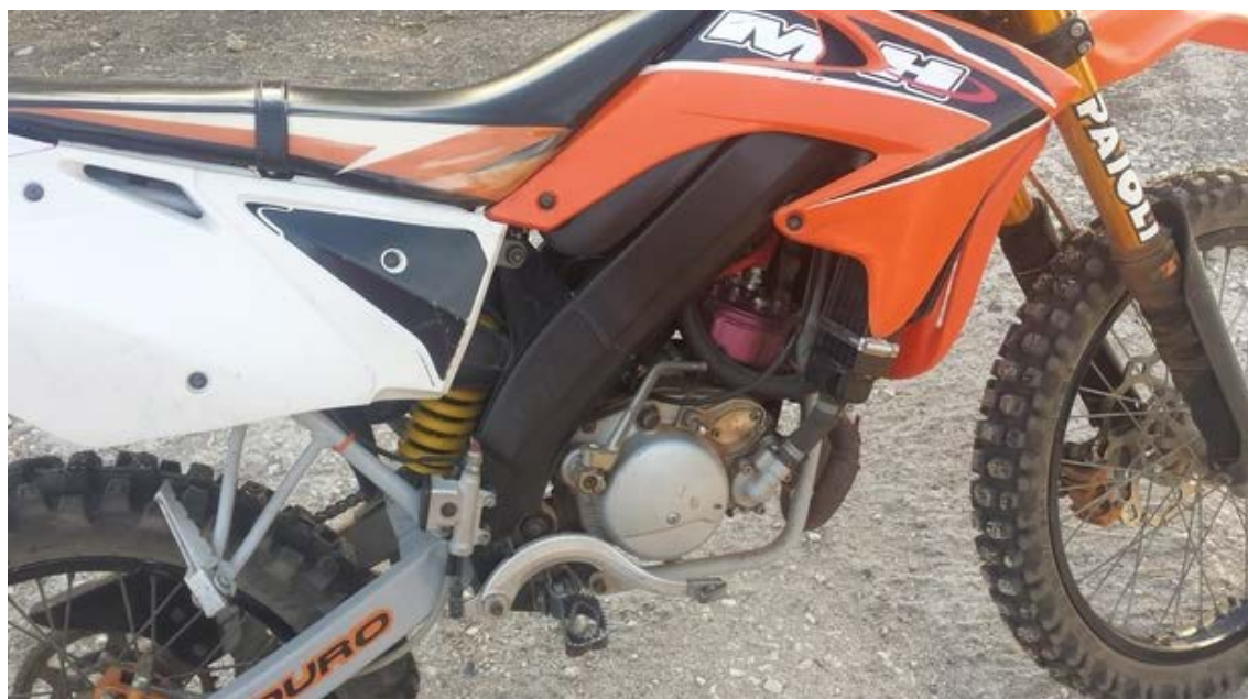
Ciclomotor MH RYZ 50cc reformado con un cilindro TOP Rosa de 80cc.
