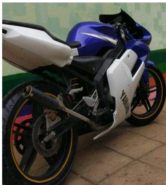
Ciclomotor sin espejos retrovisores
