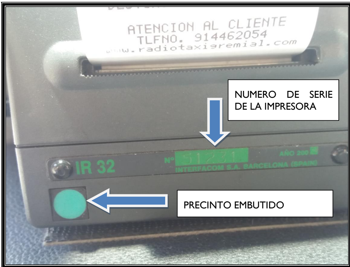
DETALLE DE LA IMPRESORA NO INCORPORADA AL TAXÍMETRO CON DATOS DE NÚMERO DE SERIE Y PRECINTO EMBUTIDO SIN MARCAJE
