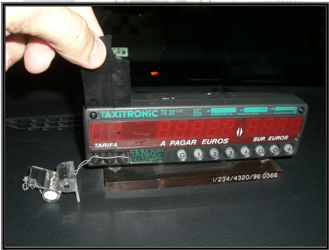
MANIPULACIÓN DE TAXIMETRO CON CINTA ADHESIVA CON INTENCIÓN DE OCULTAR AL USUARIO LA TARIFA Y CIRCULAR CON LA DE PRECIO SUPERIOR (DELITO LEVE DE ESTAFA)
