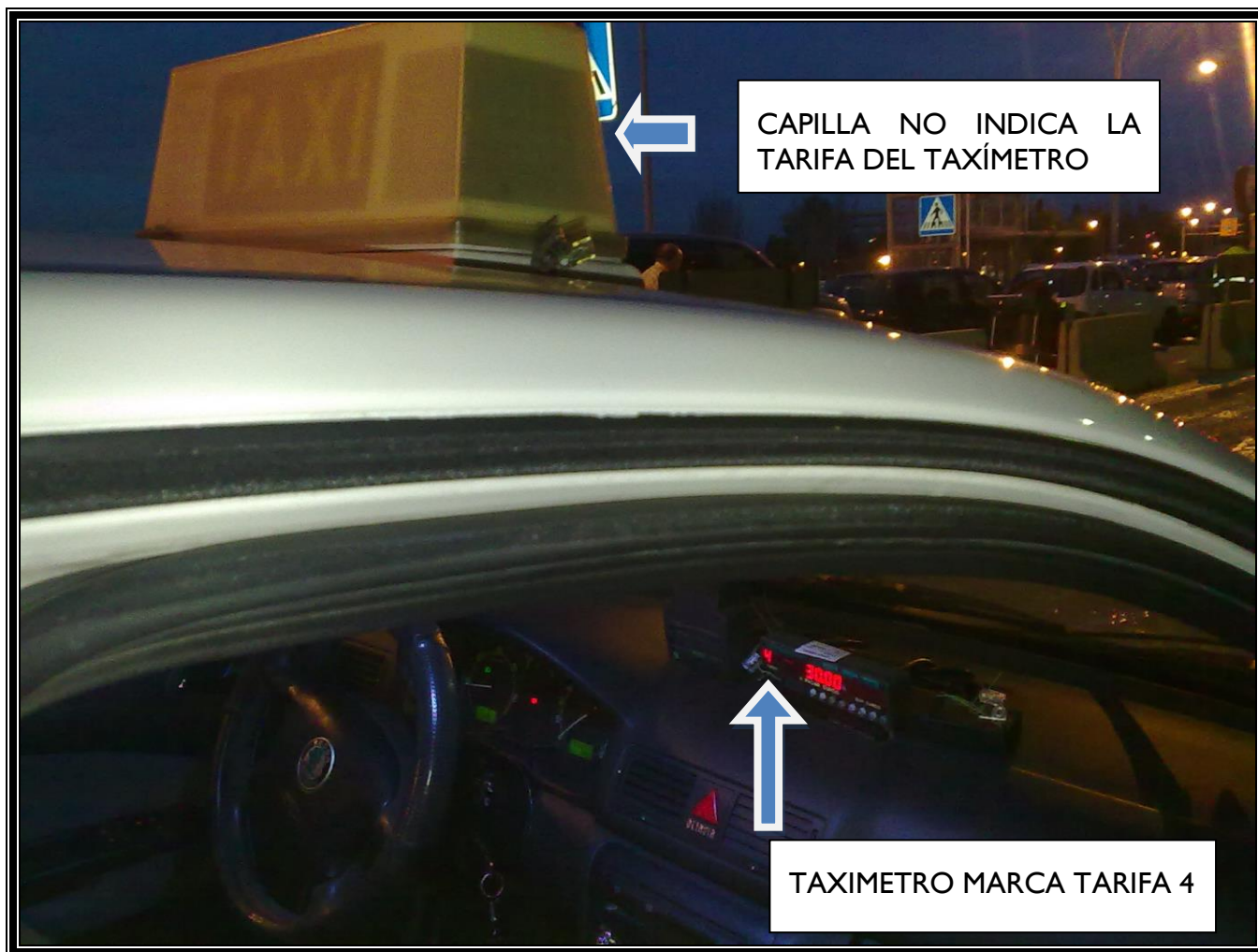
INADECUADO FUNCIONAMIENTO DE TAXÍMETRO Y CAPILLA
