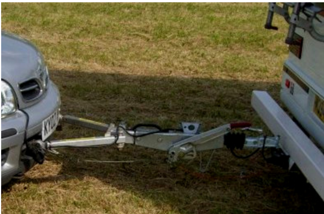
Fotografía número 1.-Sistema de enganche y remolque similar al que alude el ciudadano francés que formula la consulta.
