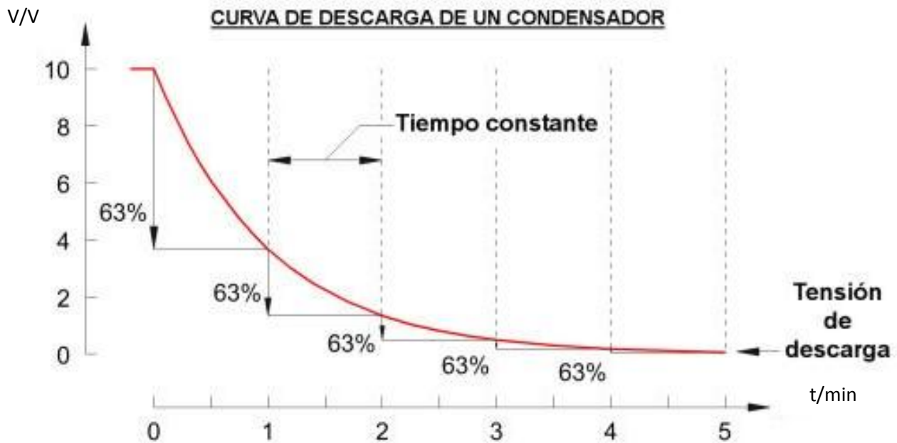
Figura 1. Curva de descarga de un condensador.
