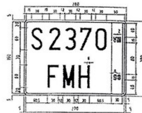
Matricula temporal empresas alta (Vehículos no matriculados) Fondo rojo. Caracteres blanco mate Banda: Fondo blanco. Caracteres rojo mate adhesivos
