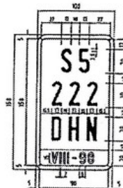
Matricula ciclomoteres temporal empresas (Vehículos no matriculados) Fondo rojo. Caracteres blanco mate Banda: Fondo blanco. Caracteres rojo mate adhesivos
