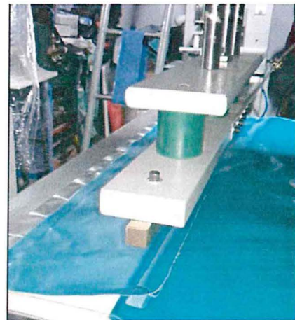
(Ejemplo de pegado de láminas de PVC con máquinas de alta frecuencia)
